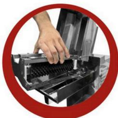
Sistema de desmontaje rápido de los rollos, facilitando la limpieza y aumentando la seguridad del trabajador.
